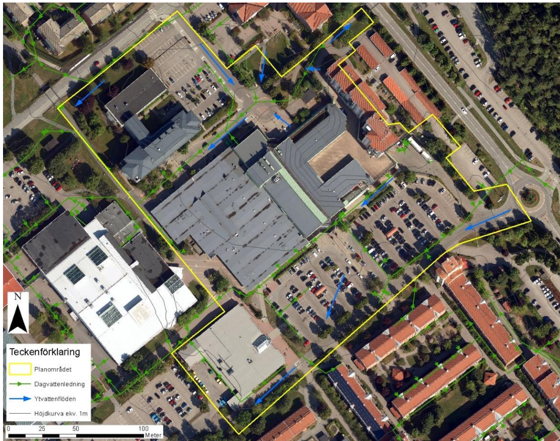
Figur 3 Ytvattnets flödesriktning inom planområdet samt de kommunala dagvattenledningarna med dagvattenflödet och höjdkurvor utifrån nuvarande höjdsättning. (Ortofoto Håbo kommun)
